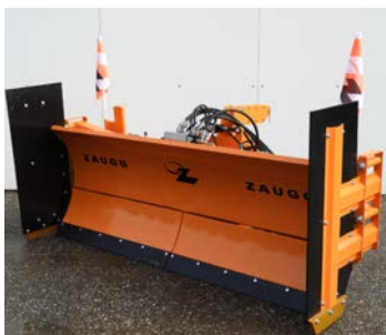
Bilder zeigen Schneepflug mit Sonderausrüstung
