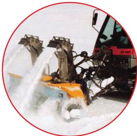
Le turbo-fraises à neige latérales sont dotées de deux cheminées d'éjection rotatives et inclinables par hydraulique, qui disposent chacune de 4 clapets. Celles-ci peuvent être commandées individuellement ou en parallèle. Les deux tambours de fraise sont logés latéralement et sécurisés par des accouplements à réarmement automatiques.
