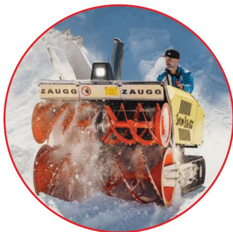
La Snowbeast est une turbo-fraise à neige à chenilles, à guidage manuel à haute performance. Grâce aux tambours de fraise disposés les uns au-dessus des autres, la Snowbeast offre une hauteur de travail pouvant aller jusqu'à 120 cm. La machine peut être pilotée aisément au moyen d'une commande ergonomique par 2 joystick.
