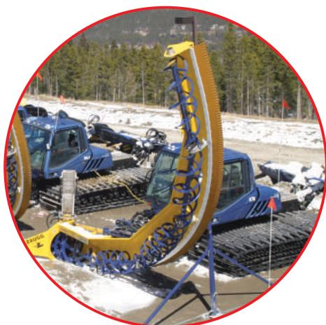
Le Pipe Designer est monté sur des véhicules de piste et entraîné par leur propre système hydraulique. Les tambours de fraise sont disposés de manière radiale et possèdent une forme spécifique au half-pipe. La neige retirée est éjectée du half-pipe par la turbine d'éjection, via la cheminée. Après le fraisage, les finisseurs fixés sur le carter lissent la surface de la neige.
